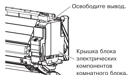
Рисунок 1: Снятие крышки с блока электрических компонентов комнатного блока
