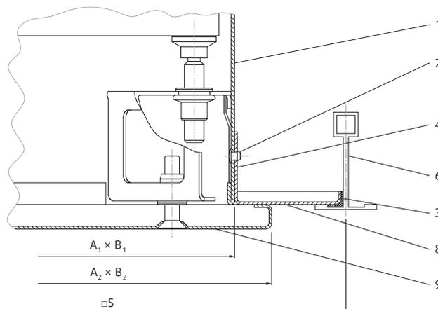
Рис. 10. Монтаж CFC, тип 2 в подвесной потолок T-bar
