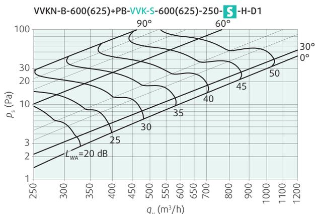
Приток: с камерой статического давления РВ-VVK для квадратной лицевой панели диффузора, с горизонтальным боковым подсоединением (Н); клапан регулируется - полностью открыт (0°) или открыт на 45°.
