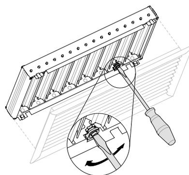
NOVA-R1, регулирующий клапан. Расход воздуха можно регулировать при помощи отвертки. Глубина решетки 40 мм.
