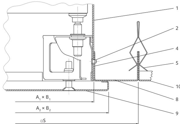
Рис. 8 Монтаж CFC, тип 2 в подвесной металлический потолок
