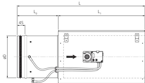
воздушного потока осуществляется с помощью специального программатора Belimo ZTH-GEN. Компактные контроллеры калибруются стандартно или по индивидуальным параметрам  $V_{min}$  и  $V_{max}$  (указываются в заказе) на заводе перед отправкой.
