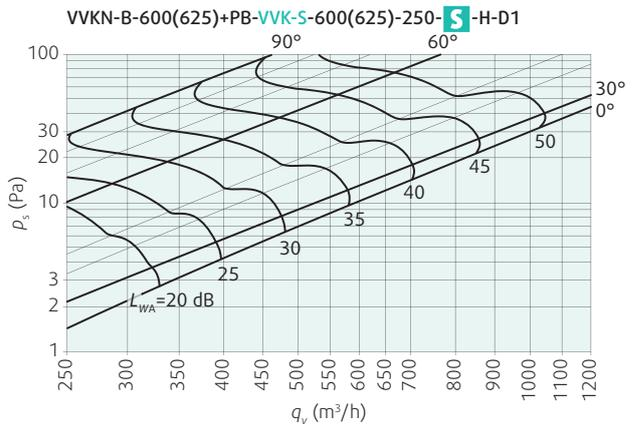
Приток: с камерой статического давления РВ-VVK для квадратной лицевой панели диффузора, с горизонтальным боковым подсоединением (H); клапан регулируется - полностью открыт (0°) или открыт на 45°.
