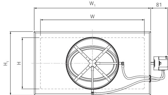
\*BLC1 = компактный контроллер Belimo LMV-D3 с MP-Bus коммуникацией
