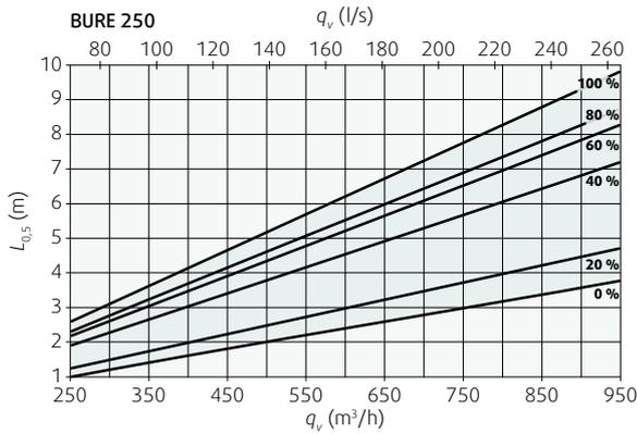
Диаграмма 1б: Дальность изотермической вертикальной струи при конечной скорости 0,5м/с. (Все типы диффузоров BURE).
