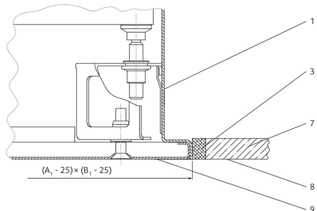
Рис. 9. Монтаж CFC, тип 1 в подвесной потолок из гипсокартона
