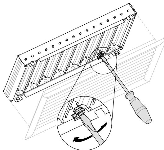
NOVA-R1, регулирующий клапан. Расход воздуха можно регулировать при помощи отвертки.
