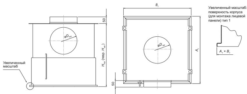
Рис. 3 Корпус CFC-G
