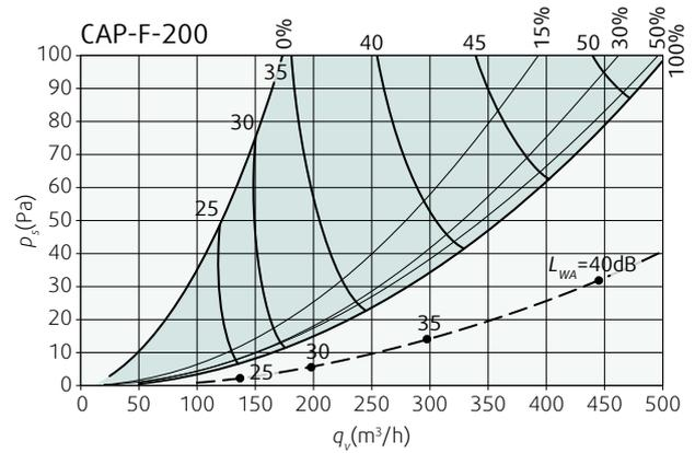
**Диаграмма 3а.** Перепад давления и уровень звуковой мощности в комплекте с камерой статического давления THOR (сплошная линия) или без (пунктирная линия)
