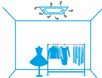
Распределение воздуха при грязном фильтре
