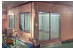
Климатическая камера для тестирования показателей работы наружных блоков в различных условиях
