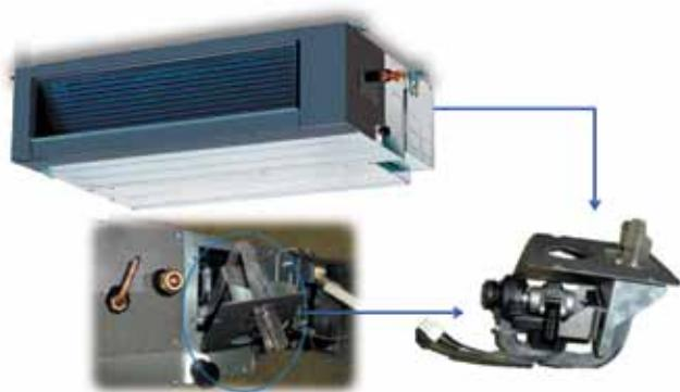
Возможна установка встроенной дренажной помпы, поднимающей конденсат на высоту до 750 мм. Это облегчает выбор места для внутреннего блока канального кондиционера.
