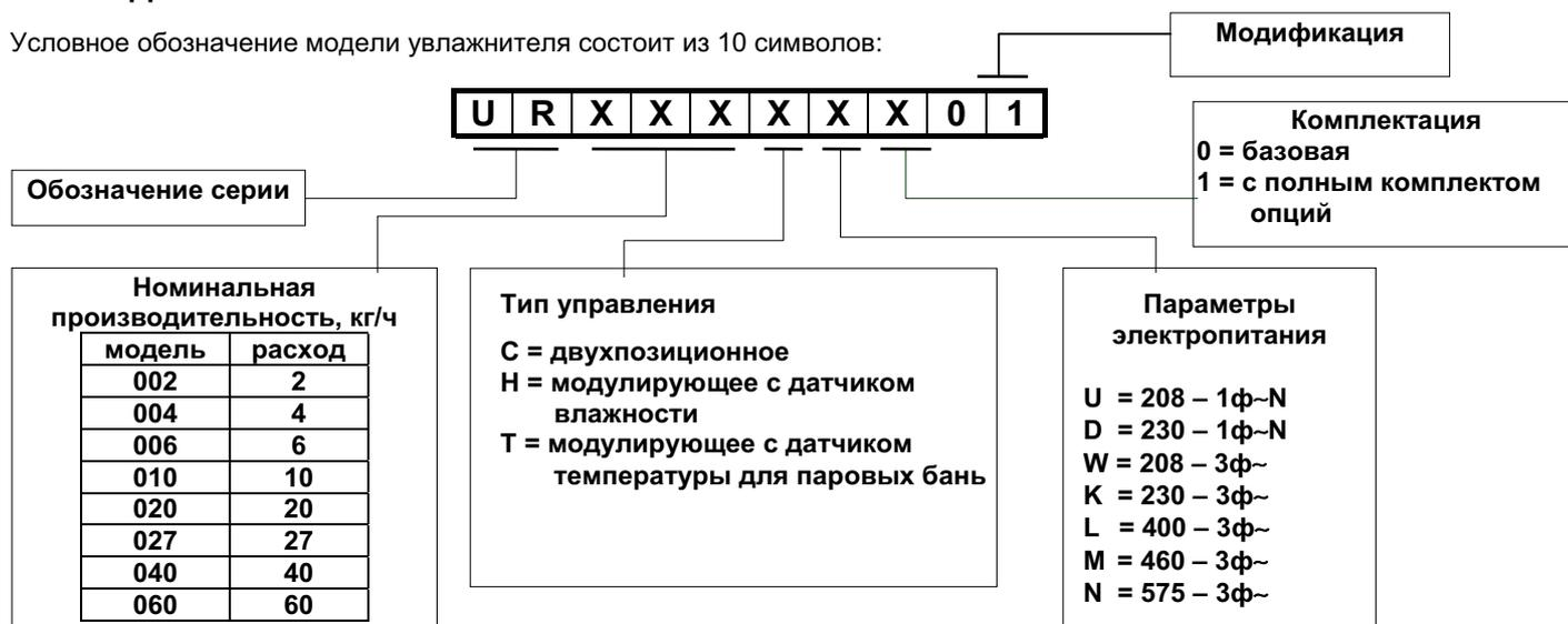
**Пример:** маркировка **UR010CL101** соответствует электронагревательному увлажнителю (серия UR) со следующими параметрами:
