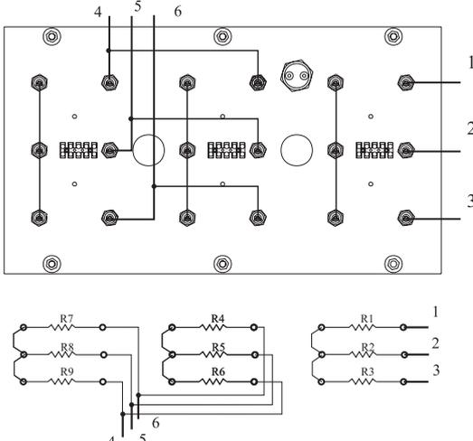
**Рис.7.7.7. 3-фазное подключение “звезда” 460 В (60 кг/час)**
