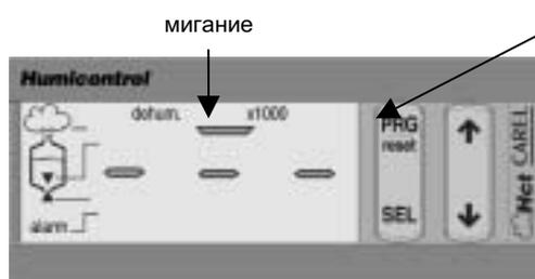
Нажать и удерживать в течение 5 сек при запуске агрегата
