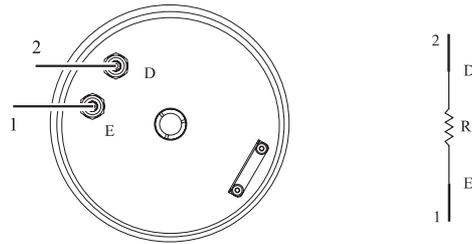
**Рис.7.7.4. 1- фазное подключение (2 - 4 кг/час)**
