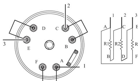
Рис.7.7.2. 3-фазное подключение «треугольник» (6-10 кг/час)
