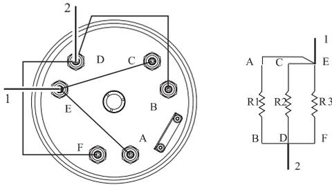
**Рис.7.7.3. 1- фазное параллельное подключение (6 кг/час)**
