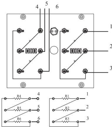
**Рис.7.7.5. 3-фазное подключение “треугольник” 208/230 В (20-27 кг/час)**
