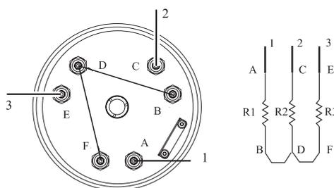
Рис.7.7.1. 3-фазное подключение «звезда» (6-10 кг/час)
