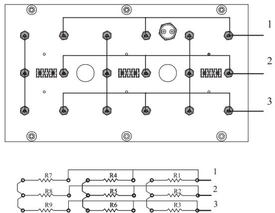
**Рис.7.7.8. 3-фазное подключение “звезда” 400/575 В (60 кг/час)**
