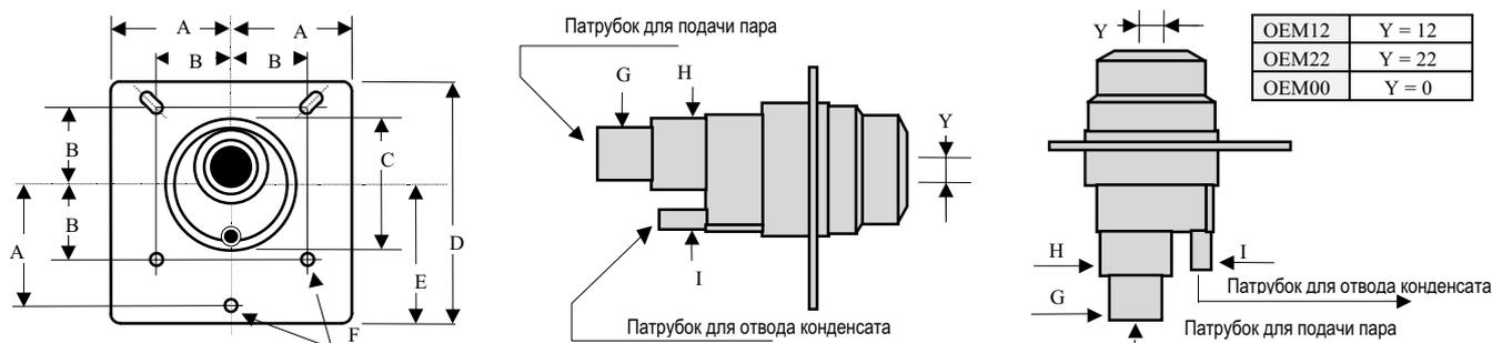
**ВНИМАНИЕ:** при использовании паропровода с внутренним диаметром 30 мм, снимите патрубок для подачи пара диаметром 22 мм
