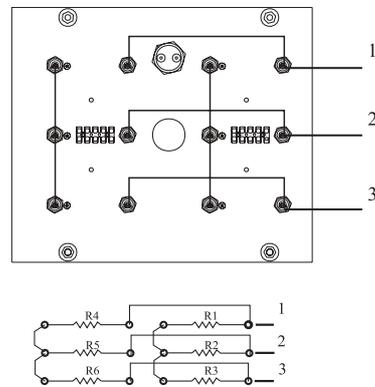
**Рис.7.7.6. 3-фазное подключение “звезда” 400/460/575 В (20-27-40 кг/час)**
