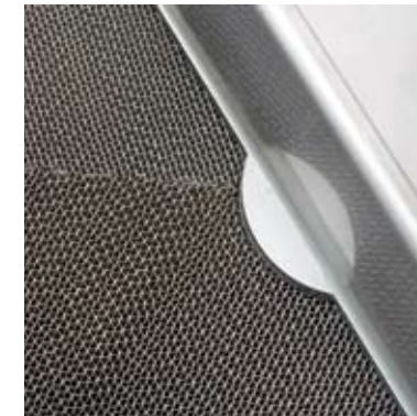
Когда ротор находится в осушаемой зоне, он впитывает влагу силикагелевой поверхностью. В зоне регенерации влага высвобождается, и ротор снова может поглощать влагу при выходе в зону осушения.
