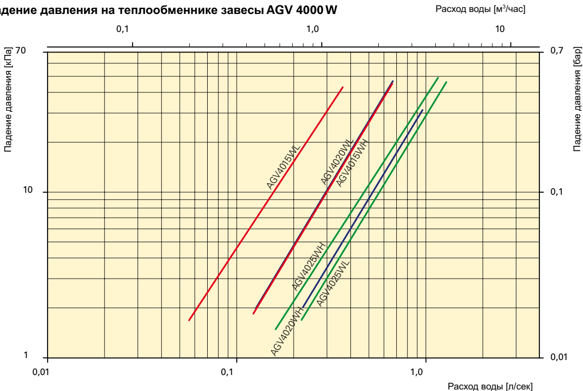
Падение давления на теплообменнике завесы AGV 4000 W
