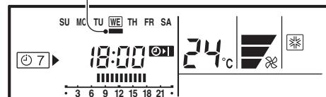
напр., таймер установлен на 7:00-18:00.
