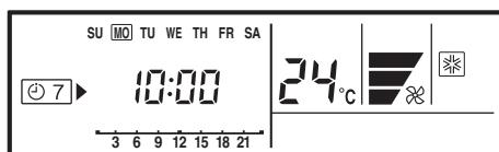
Нажмите кнопку настройки таймера для выбора недельного таймера.
