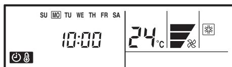
напр., информация дисплея при работе таймера SET BACK
