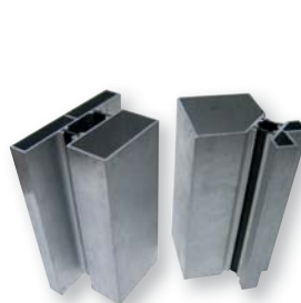
Алюминиевый профиль с термовставкой для уменьшения энергопотерь
