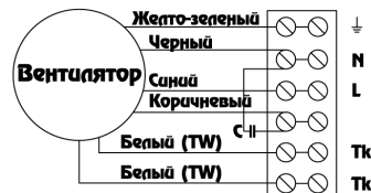
Схема № 6 ~ 220В, 1 фаза, вынесенный термодатчик
