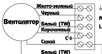
Схема № 5 ~ 220В, 1 фаза, внутренний термодатчик
