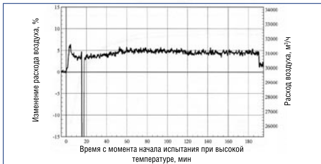
Изменение расхода воздуха в течение испытания при высокой температуре
