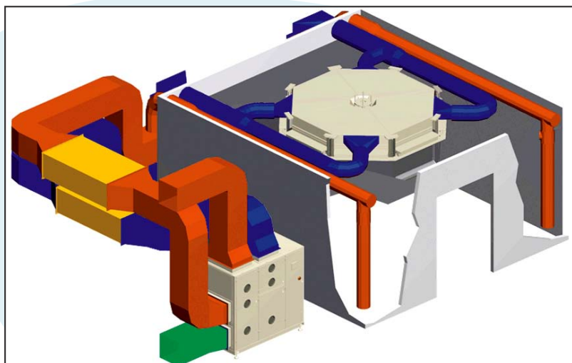
Рис. 20. Схема совместного использования кондиционера Tescnair LV серии H и статического ламинарного потолка
