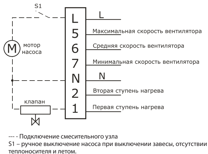
Электрическая схема подключения дистанционного пульта управления IR01
